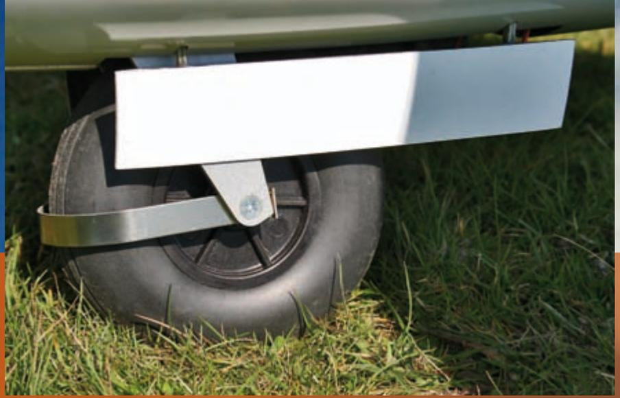
Das eingebaute FEMA Einziehfahrwerk, ungedämpft und ungebremst, aber perfekt eingebaut. Die Einziehfahrwerksklappen sind ideal gelagert und auf lange Lebenszeit ausgelegt.
