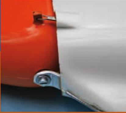
Seitenruderlagerung und -anlenkung. Die ASW15 hat nur einen Schleifsporn, hier ein 2-mm-Stahldraht.
