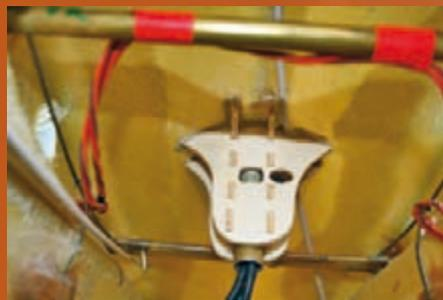
Der eingeharzte EMA-Sperrholzträger, vorne die Klemmung für die Steckung des EMA Scale 800.
