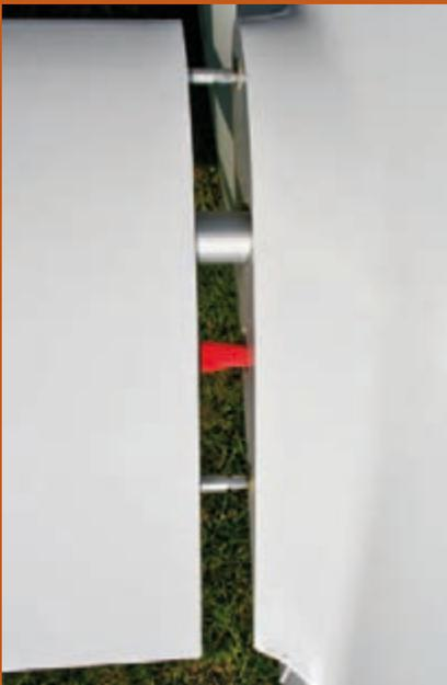
◀ Flächenanschluss: Die Steckung ist schwimmend, arretiert von zwei Alubolzen vorne und hinten.
